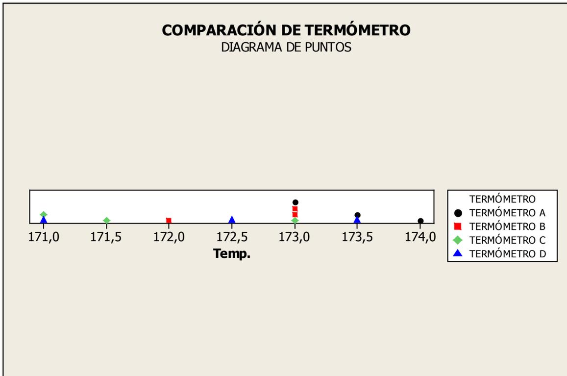
Figura 4: Diagrama de puntos de los datos de los termómetros
