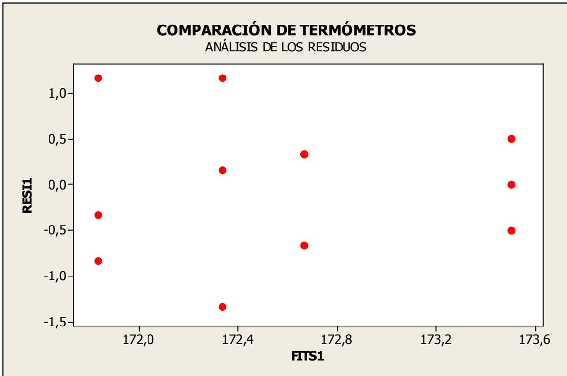
Figura 5: Análisis de tendencias de los residuos en función de la temperatura
