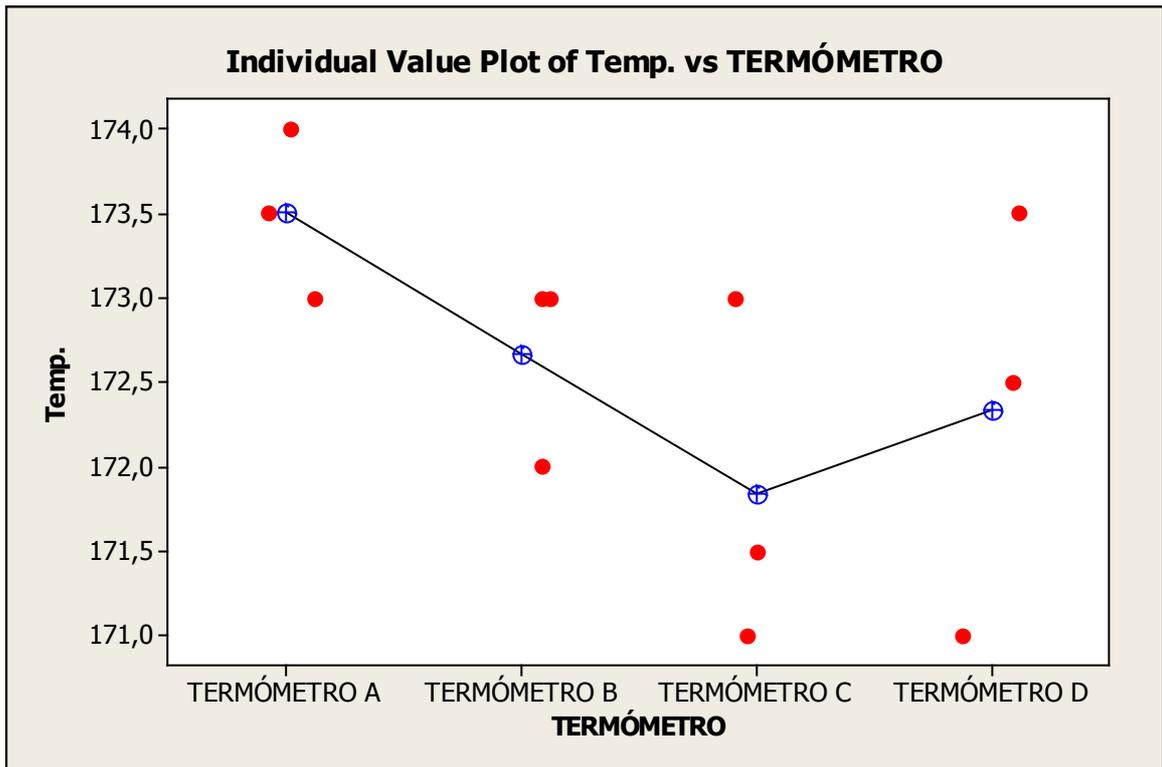
Figura 7: Variabilidad de los datos en cada termómetro
