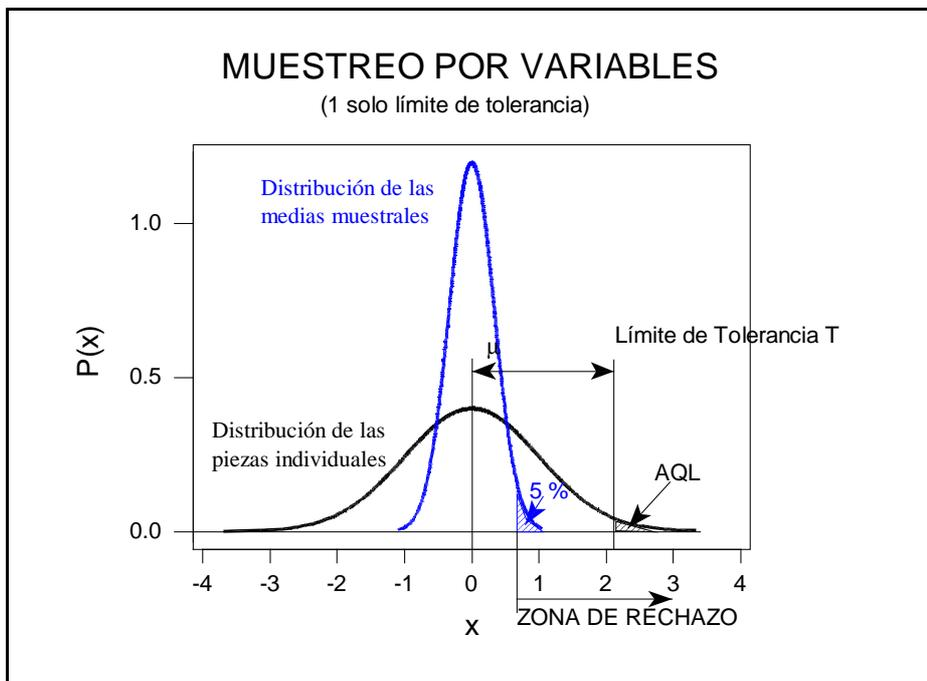
**Fig. 8 Un solo límite de tolerancia**
