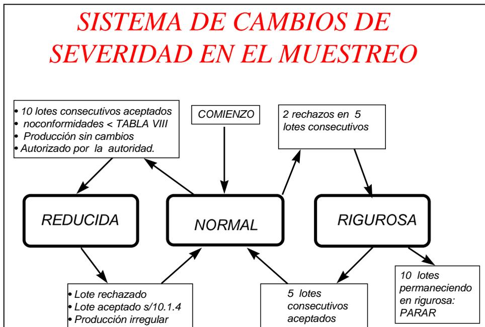
**Fig. 7 Modificación de la inspección en MIL-STD-105E**
